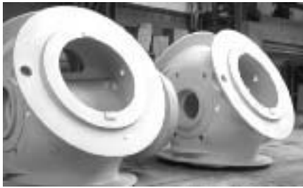
Naben für Windräder, gefertigt in der Voith Gießerei in Heidenheim
